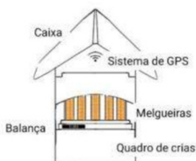
Figura 1 - A idealização da colmeia com as tecnologias inseridas para enviar os dados para o aplicativo.
